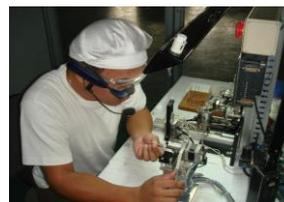
CSIが導入しましたウェアラブル・カメラは、眼鏡型カメラです。このカメラは、WIFIを通して内臓カメラの画像を遠隔地のPCと共有することができます。また、遠隔地側からもPCを通して、音声、画像データをカメラ側に送ることができます。このウェアラブル・カメラのメリットは、ライブ中継にて協同で業務遂行できることにあります。例えば、CSIでの設備メンテナンスもメンテナンス作業員へ、SSD側から指示をその場で出すことにより、今まで出張対応をしてきたことが遠隔操作できるわけです。
