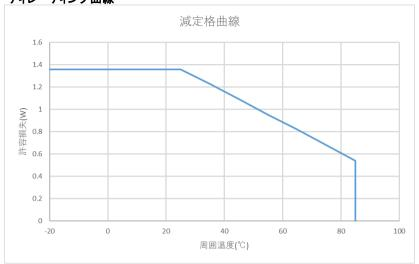
許容損失 $Pd = Vo \times Io \times \left(\frac{100}{\eta} - 1\right)$
